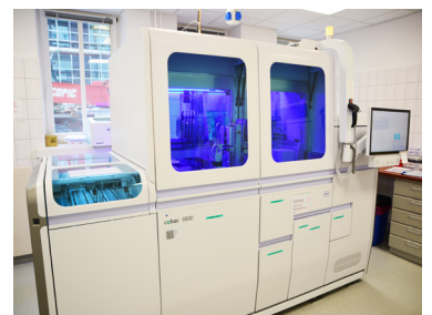
unten: In einem Analyse-Automaten werden in einem abgeschlossenen System Blutproben auf Viruserkrankungen wie HIV und Hepatitis überprüft.
