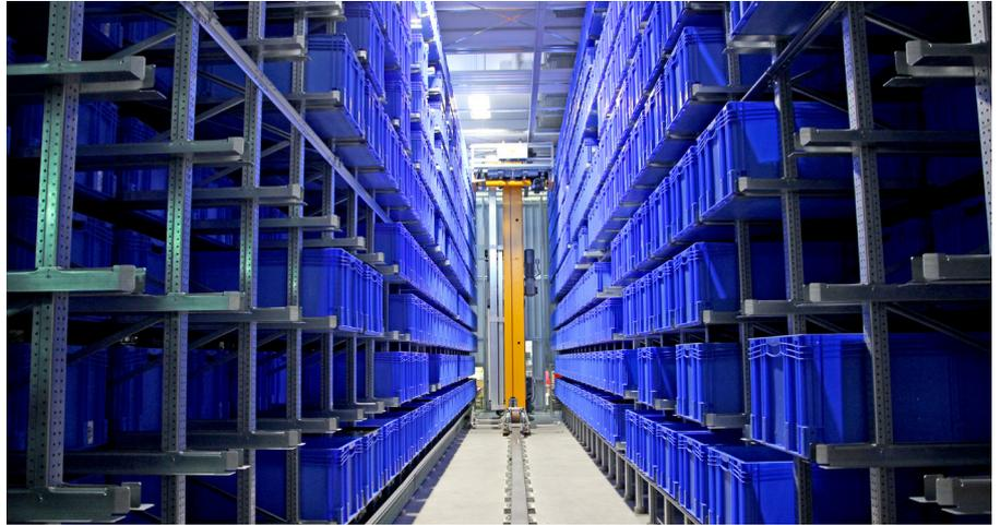
Über drei Etagen hoch und 25 Meter breit - auf rund 500 Quadratmetern sind im Hochregallager mehrere tausend Waren untergebracht. Der gelbe Greifarm sucht die angeforderte Bestellung automatisch heraus.
